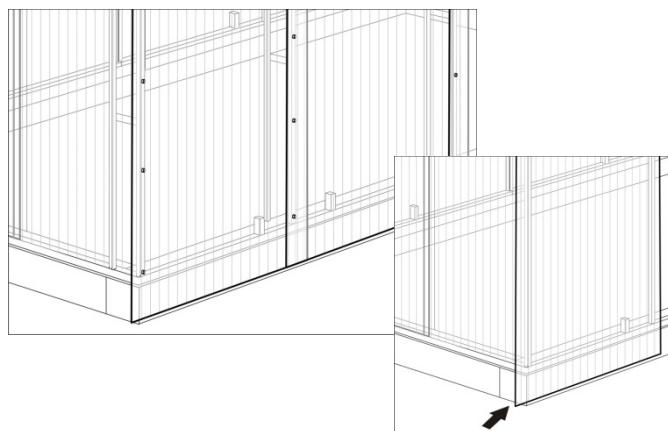
**ВНИМАНИЕ!** При креплении поликарбоната к каркасу, необходимо соблюдать направление крепления. Например, крепить поликарбонат по дуге, слева направо, слегка натягивая и проглаживая его для препятствия образования пузырей между дугой и поликарбонатом. Крепить поликарбонат сначала у основания дуг с двух сторон, а потом вверху **НЕПРАВИЛЬНО**.
