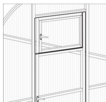
поликарбоната за арочную часть, затем прорезать проем форточки и двери и прорезать поликарбонат на петлях, чтобы он не мешал открыванию и закрыванию двери и форточки. Ручки для дверей необходимо
